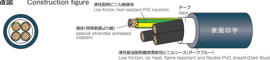
※10AWG以上は軟銅より線 / 10AWG or larger : annealed copper.
