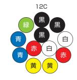
電気用品安全法 電気用品の技術上の 適合規格 Applicable standard 基準を定める省令 形式記号 Official symbol 3PNCT 定格雷圧 Voltage rating 600V 80°C 定格温度 Temperature rating JIS C 3152 体 Conductor 難 燃 性 Flame rating JIS C 300504.26.20a)
